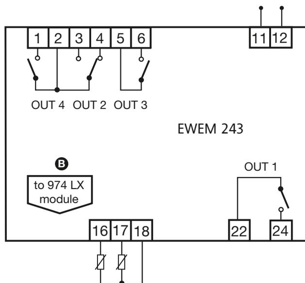
**Tutte le uscite relé (OUT) del modulo EWEM 243 sono configurabili tramite parametro in base alla seguente tabella:**
