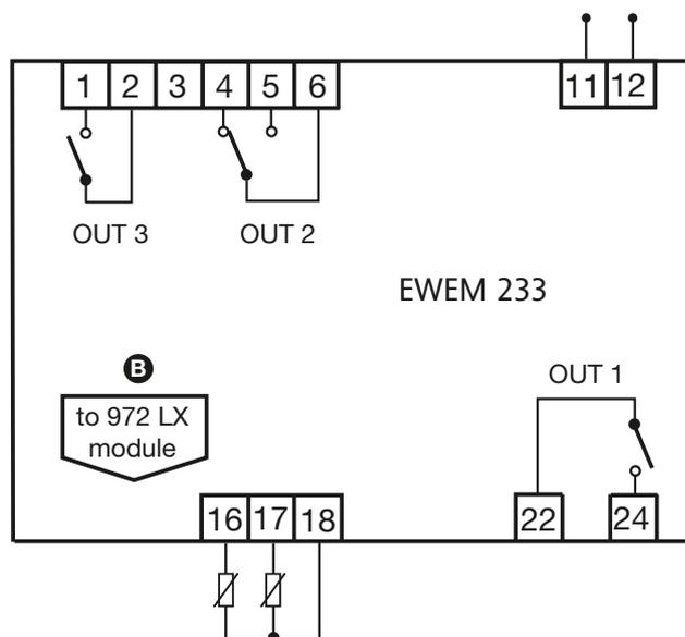
**Tutte le uscite relé (OUT) del modulo EWEM 233 sono configurabili tramite parametro in base alla seguente tabella:**
